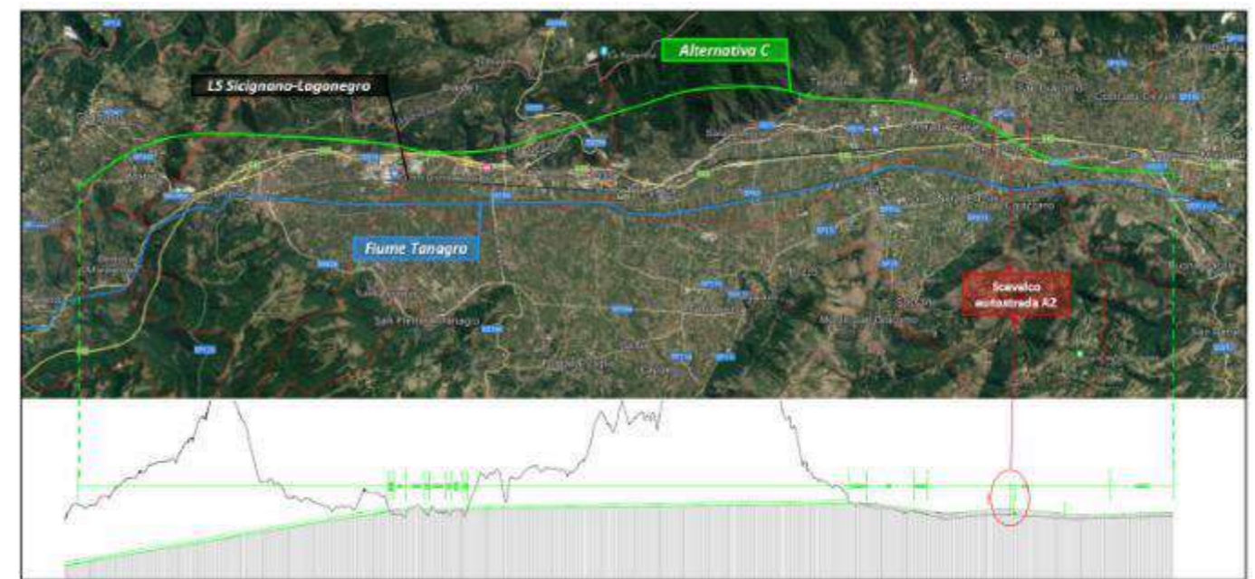
Figura 29 Profilo piano-altimetrico dell'alternativa di tracciato "C"
