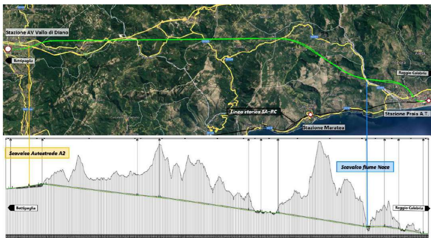
Figura 17 Profilo piano-altimetrico dell'alternativa di tracciato A
