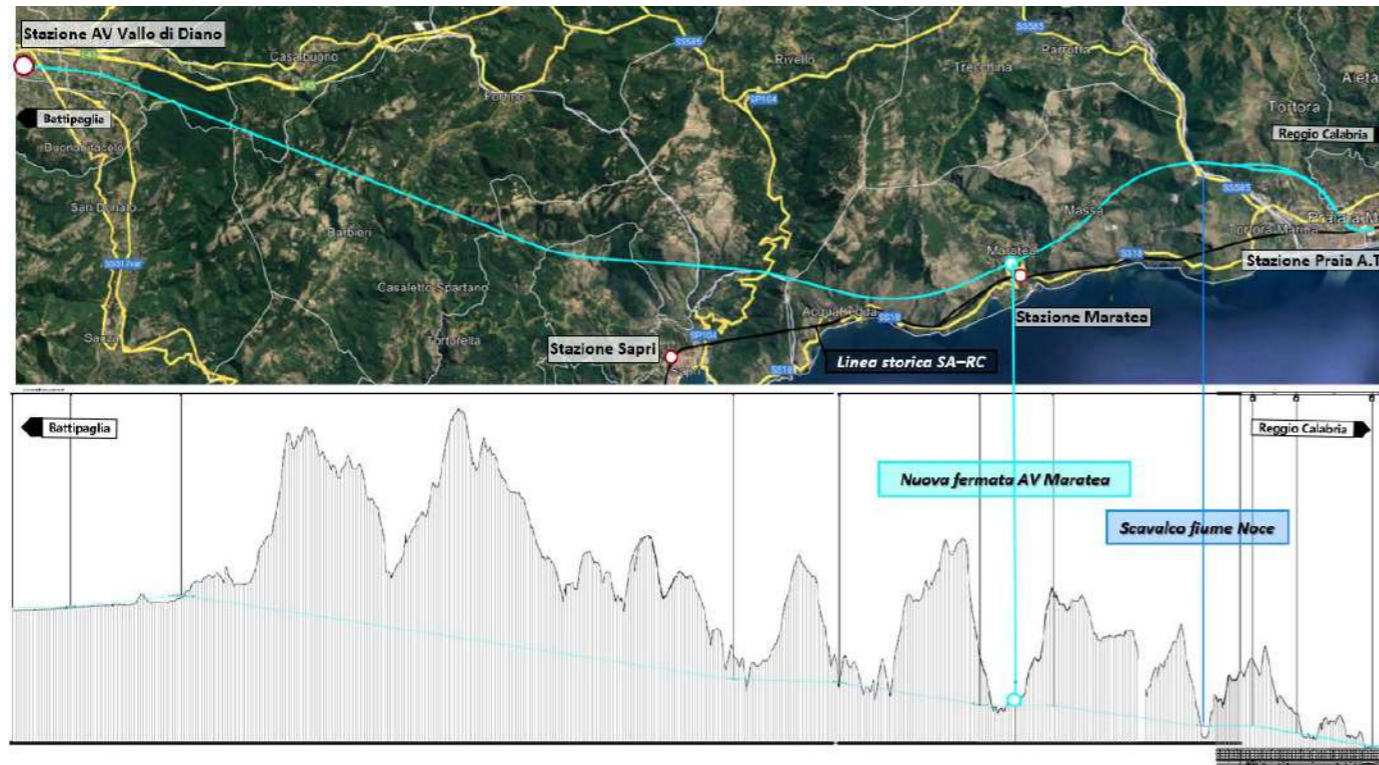
Figura 19 Profilo piano-altimetrico dell'alternativa di tracciato
